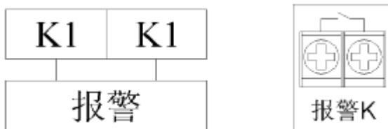
图5 继电器触点输出接线图
