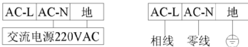
图3 交流电源 220VAC 输入接线图
